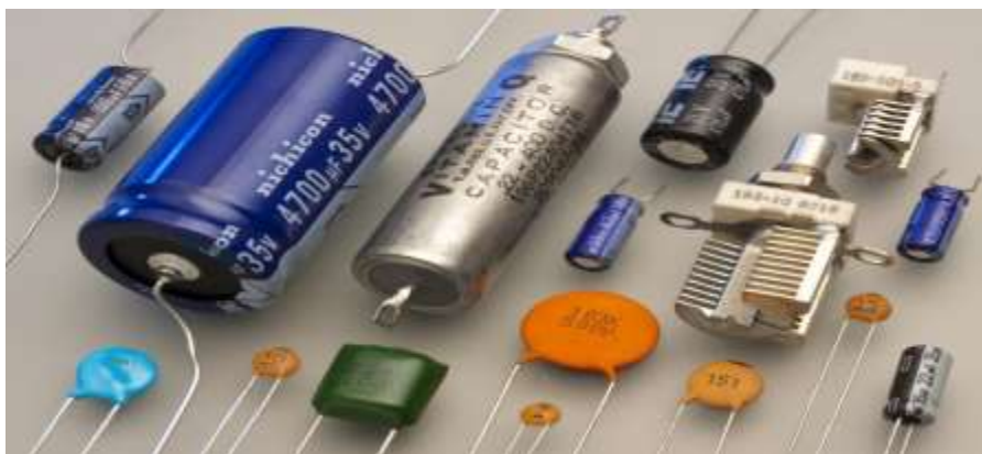
شکل ۱-۵: انواع مختلف خازن
