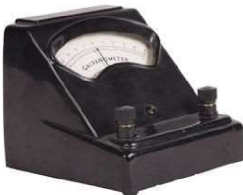
شکل ۸-۱: نمونه ای از گالوانومتر
