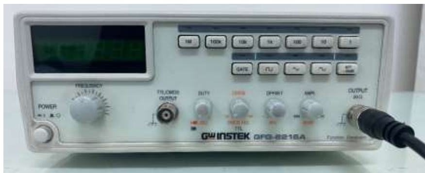
شکل ۱-۱۴: نمایی از دستگاه سیگنال ژنراتور
