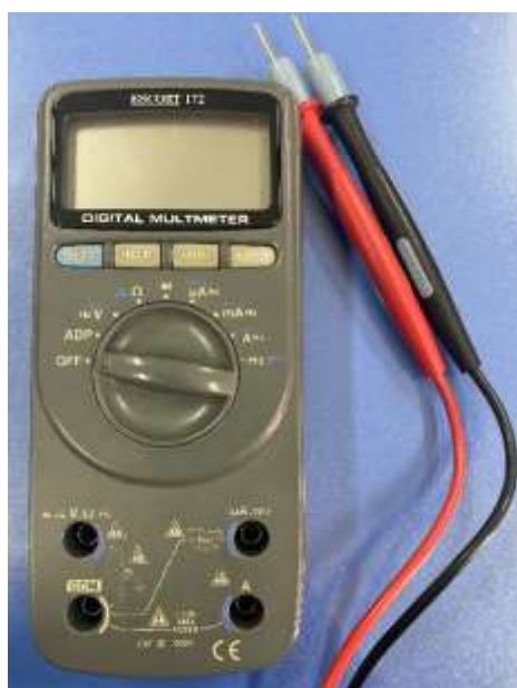
شکل ۱-۱۱: نمونه‌ای از مولتی‌متر دیجیتال
