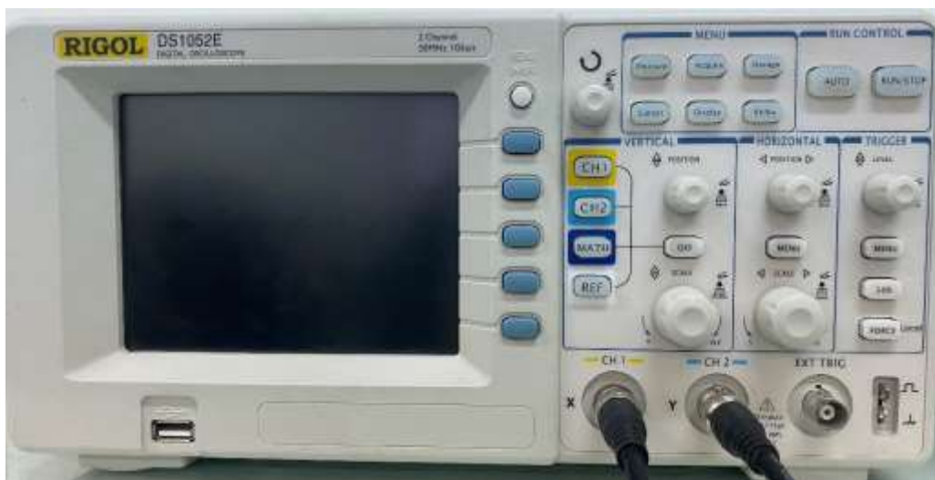
شکل ۶-۱: نمایی از اسیلوسکوپ دیجیتال از نزدیک
