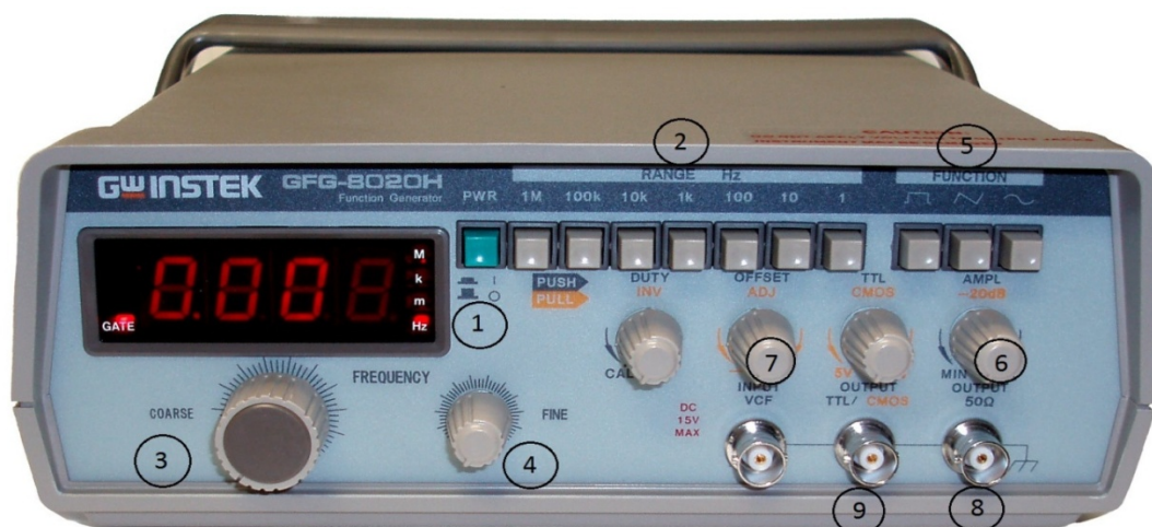
شکل (۲): قسمت‌های مختلف یک سیگنال ژنراتور
