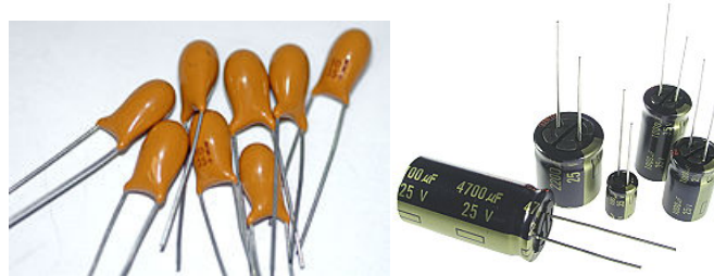
شکل (۸) : به ترتیب از راست به چپ نمونه‌ای از خازن‌های الکترولیتی آلومینیومی و تانتالیومی
