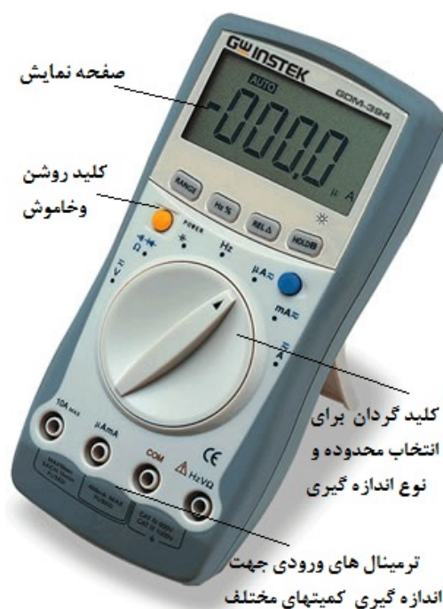
شکل (۲): قسمت‌های کلی یک مولتی‌متر دیجیتال
