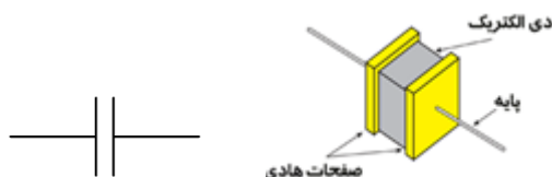
شکل (۱): علامت اختصاری و قسمت های مختلف خازن
