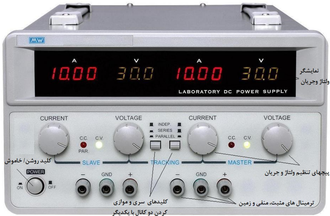
شکل (۲): قسمت‌های کلی یک منبع تغذیه DC
