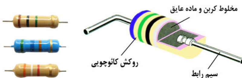
شکل (۴): نمونه‌هایی از این انواع مقاومت و ساختمان داخلی مقاومت کربنی
